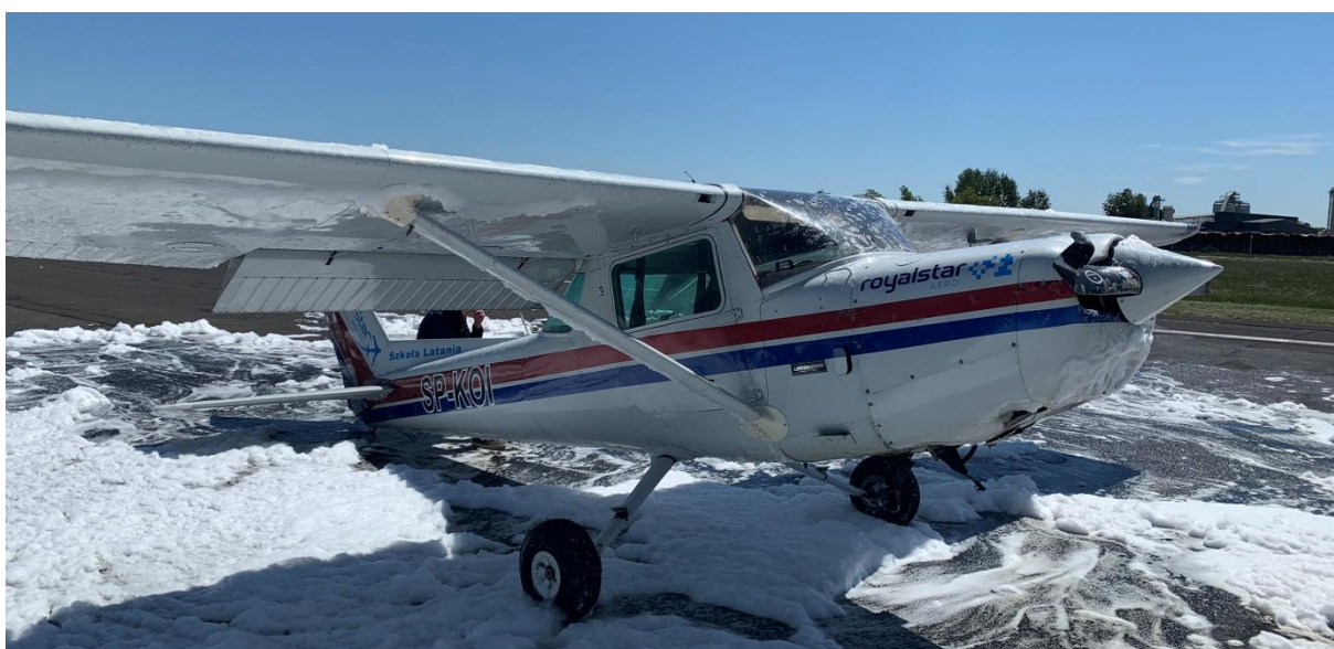
Rys. 3. Widok na samolot po lądowaniu. Widoczne uszkodzone śmigło, brak goleni przedniego podwozia oraz uszkodzenia maski silnika i kolektora wydechowego [źródło: Royal-Star]
