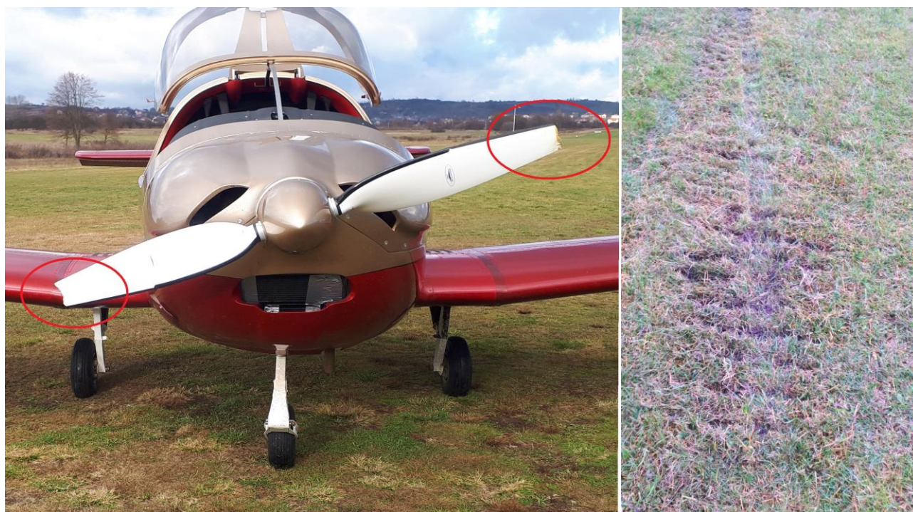
Rys. Na zdjęciach widać uszkodzenia śmigła samolotu i ślady pozostawione przez śmigło na trawiastej nawierzchni pasa startowego [źródło: użytkownik].
