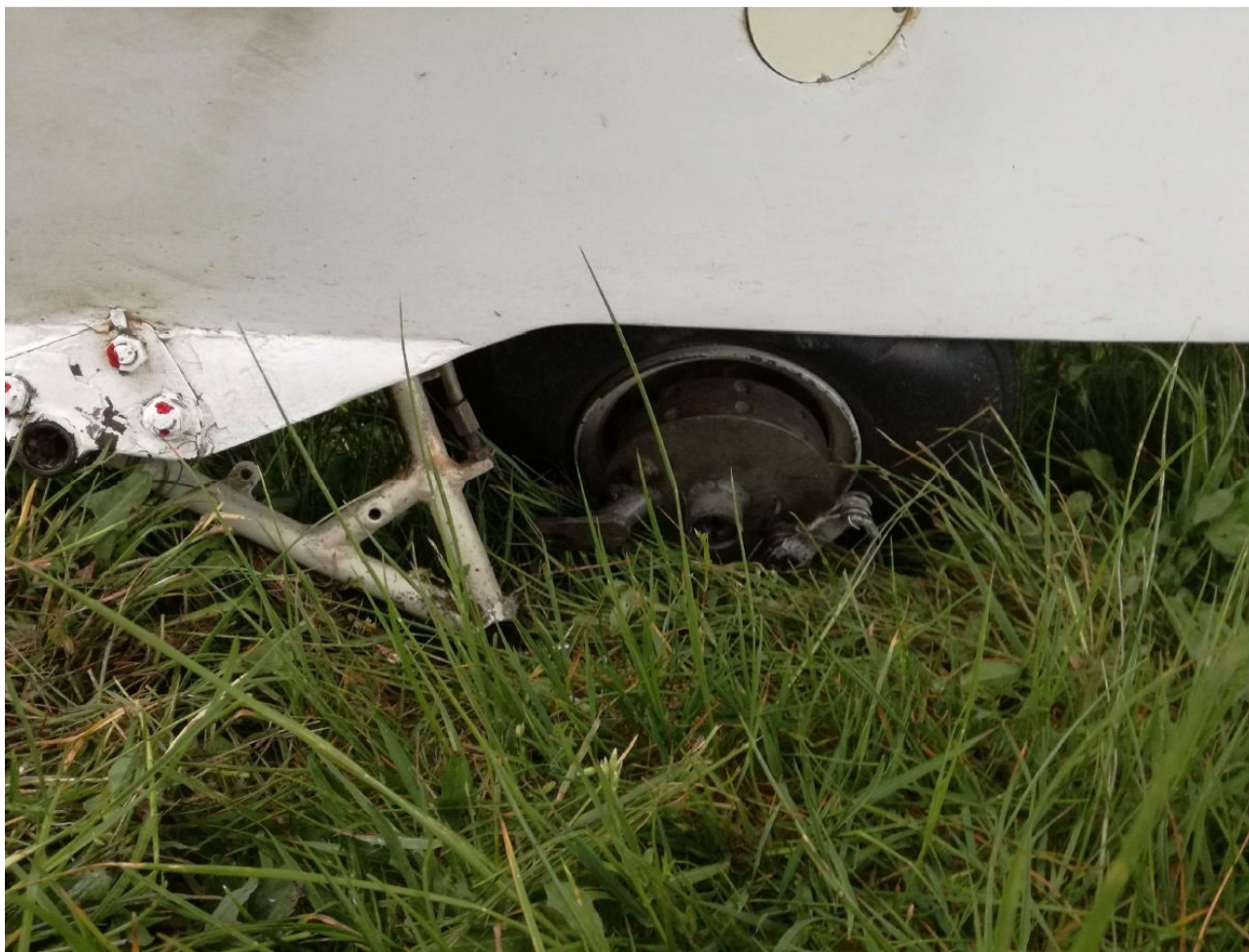
Rys. 1. Wyłamana kratownica podwozia [źródło: użytkownik]
