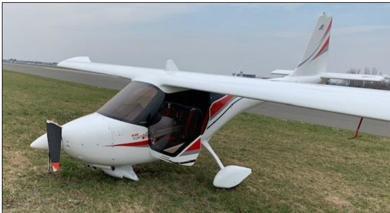
Rys. 3. Widok na samolot po zakończonym dobiegu. Widoczne uszkodzone śmigło. [ Źródło: właściciel samolotu]
