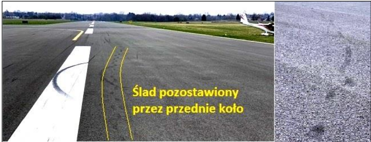
Rys.1. Ślad zostawiony na dobiegu przez oponę przedniego koła. [ Źródło: właściciel samolotu]
