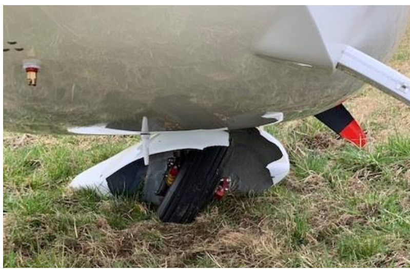
Rys.1. Ślad zostawiony na dobiegu przez oponę przedniego koła. [ Źródło: właściciel samolotu]
