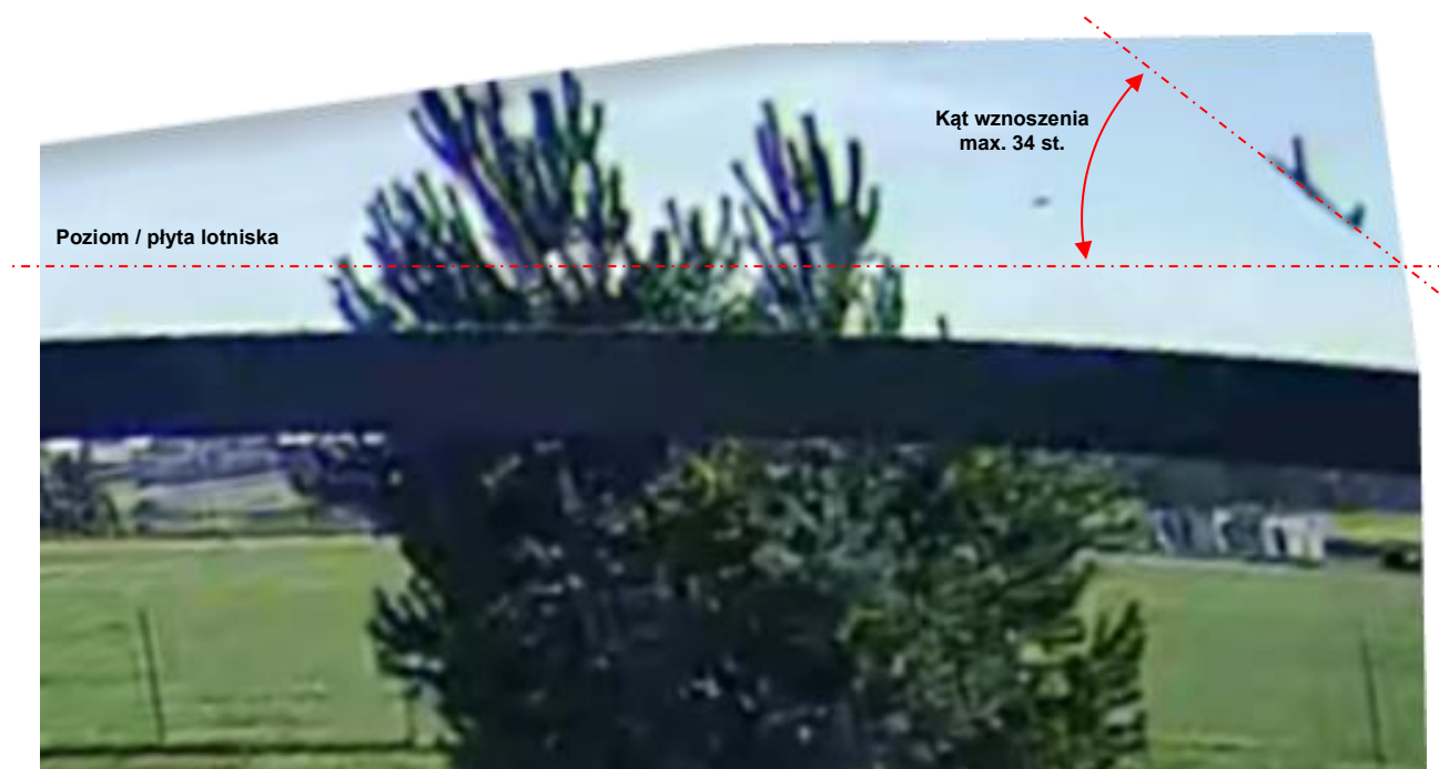
Rys. 8. Przybliżone określenie maksymalnego kąta wznoszenia na ciągu (po uwzględnieniu zniekształcenia obiektywu)
