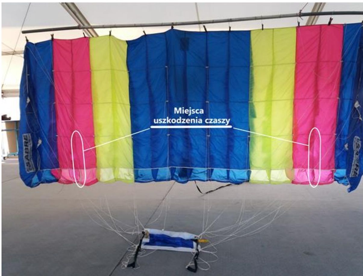
Rys. 2. Widok na czaszę spadochronu. Zaznaczono miejsca w których czasza spadochronu została rozerwana [źródło: PKBWL]
