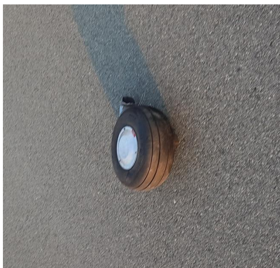
Rys. 2. Urwane koło głównego podwozia [źródło: PKBWL]
