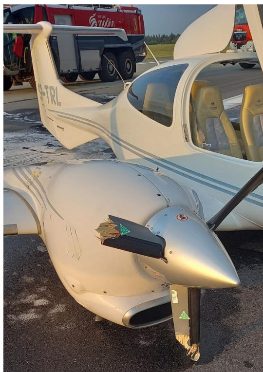
Rys. 3. Uszkodzone śmigło silnika prawego [źródło: PKBWL]
